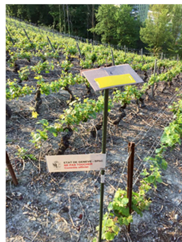
Photo 5: Papier hydrosensible pour mesurer et contrôler les dérives lors de l'application
