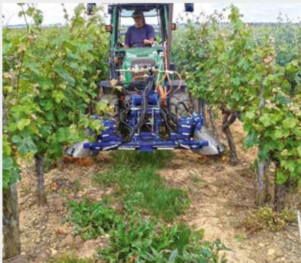
Figure 7 | Désherbage thermique (Source: etrbreton.fr).
