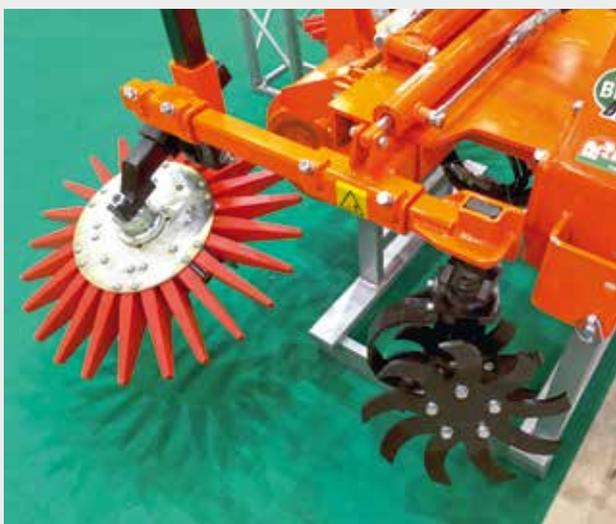
Figure 11 | Etoiles bineuses et disques émotteurs (Source: Proconseil).
