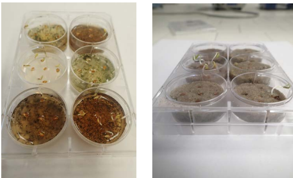
Figure 2. Biotests de screening pour la mise en évidence des propriétés phytotoxiques de tissus végétaux : a) à gauche, sur milieu gélosé, b) à droite, sur sable de silice.
